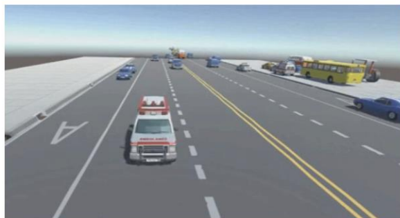
Рисунок 1 - Моделирование проезжей части и случайное появление видов автомобилей на спецполосе с использованием программного продукта Unity для формирования Dataset
